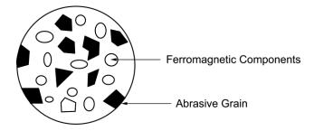
Fig. 4.12. Magnetic Abrasive Particle
