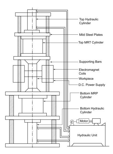
Fig. Magneto rheological abrasuive flow finishing
